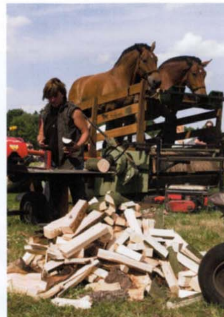
De enige in Europa staande, door twee paarden aangedreven, tredmolen werd gedemonstreerd. Hij wordt gebruikt om machines aan te drijven zoals hier een zaag en houtsplitser.
